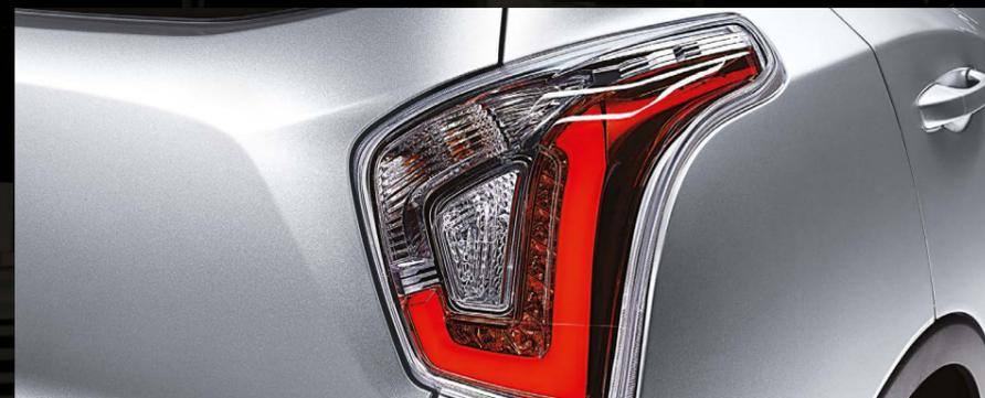
Задние светодиодные фонари комбинированного типа
