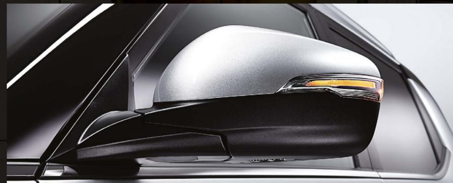
Наружные зеркала со встроенной LED лампой
