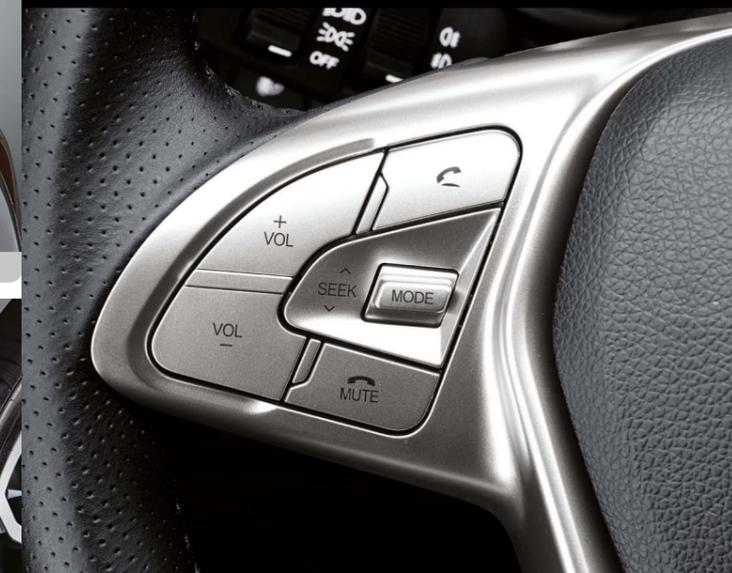
Кнопки дистанционного управления аудиосистемой на рулевом колесе
