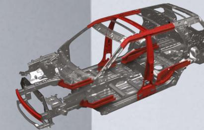
Пластины из сверхпрочной стали в десяти ключевых точках каркаса для дополнительного повышения уровня безопасности пассажиров
